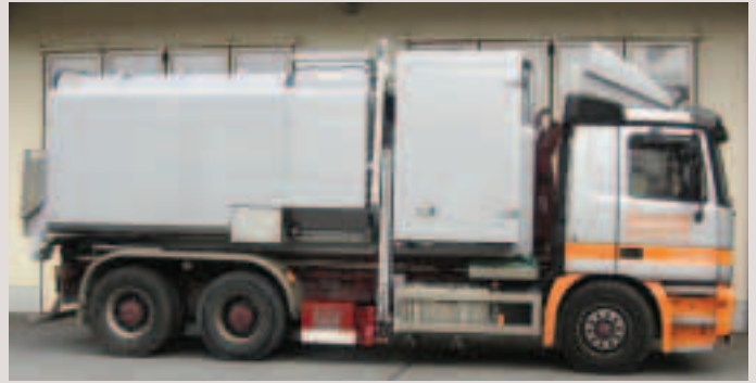
Flexibel einsetzbar durch Hakengerät-Wechselsystem
