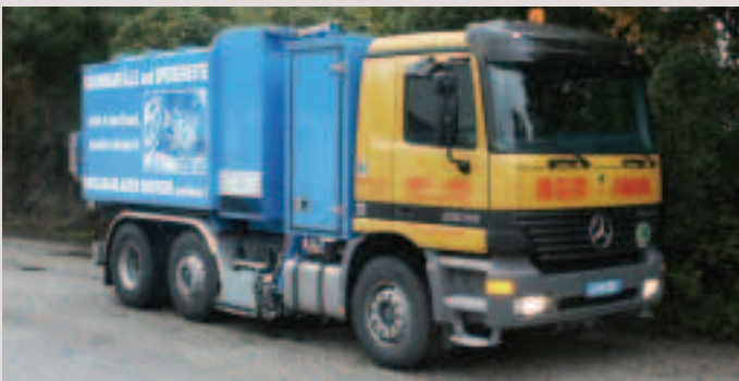
Winterbetrieb – kein Problem! Alle Pumpen und Aggregate in isoliertes Abteil eingebaut
