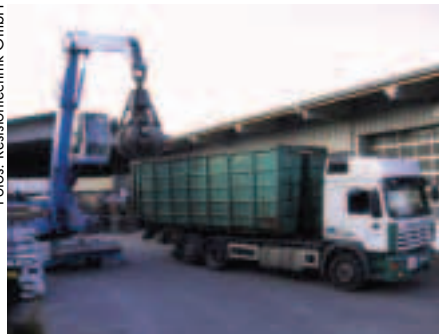
Zur optimalen Verladung unerlässlich: der Fuchs Umschlagbagger mit erhöhter Kabine.
