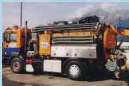
Hochdruck-Spül- und Saugfahrzeug mit Wasserrecycling – gemäß BMVIT ein Lkw zum Transport von Gütern?
